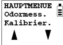
Aus dem Hauptmenü heraus können die einzelnen Menüpunkte ausgewählt werden. Mit den Tasten F1 und F2 wird durch hinauf- und hinunter scrollen die Auswahl des gewünschten Menüpunktes getroffen. Der Menüpunkt ist dabei durch eine Markierung hervorgehoben. Neben „Hauptmenü“ und den Pfeiltasten werden immer zwei Untermenüs angezeigt. In das entsprechende Menü gelangt man dann über die Taste „Menu (on/off)“.
